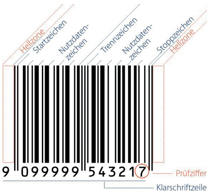
Foto: Aufbau eines EAN-13 Strichcodes. © GS1 Austria
