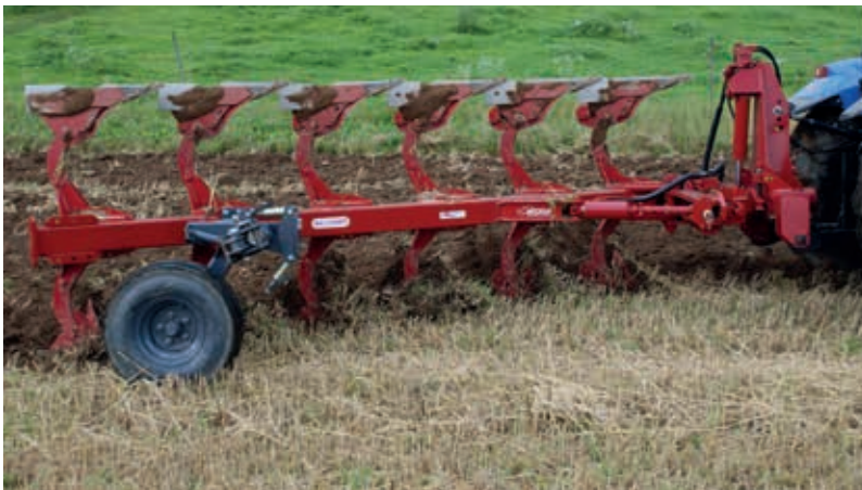
Stoppelbearbeitung mit einem Schälpflug (Precilab). Es werden nur die obersten 10 cm bearbeitet. Die Tiefe kann über das Stützrad eingestellt werden. Die Wurzelunkräuter werden durchtrennt und liegen oben auf, wo sie vertrocknen.
